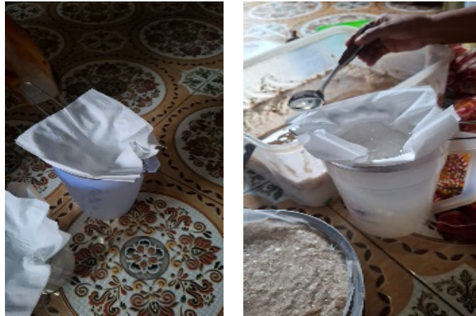
Gamba 10. Proses penyaringan minyak
