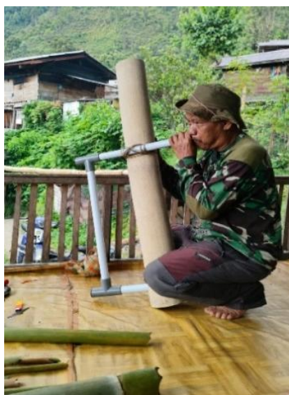
Gambar 4. Penyetelan frekuensi nada dilakukan dengan memotong ujung tabung bambu secara bertahap
